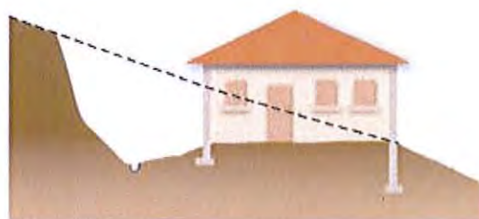
Plate-forme en déblais
