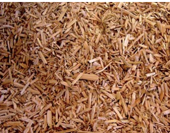
Laine de chanvre en vrac mise en œuvre dans une ossature bois
